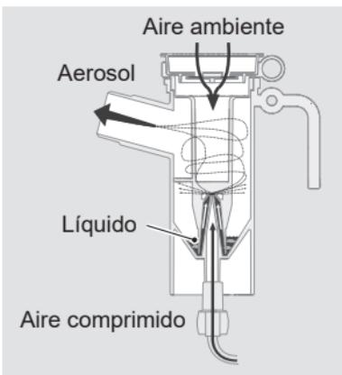
El dispositivo interruptor LC permite interrumpir la generación de aerosol durante la espiración y de ese modo optimizar el aprovechamiento del fármaco.
