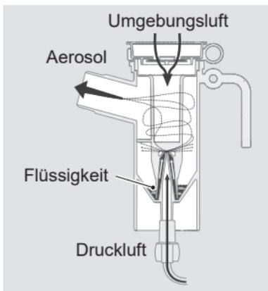
Der LC Unterbrecher ermöglicht es, die Aerosolerzeugung während des Ausatmens zu unterbrechen und dadurch die Medikamentenausnutzung zu optimieren.
