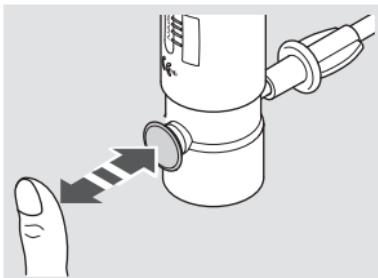
Si vous souhaitez une nébulisation permanente et que l'interrupteur LC est monté :
