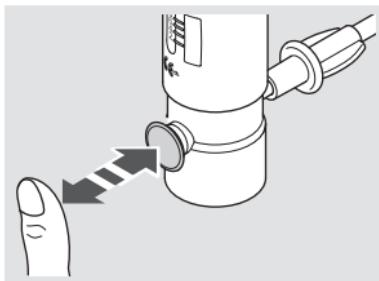
**Info:** *Falls sich die Taste nicht drücken lässt, ist sie festgestellt und der LC Unterbrecher auf Dauervernebelung eingestellt. Lösen Sie in diesem Fall die Unterbrechertaste, indem Sie diese gegen den Uhrzeigersinn bis zum Anschlag drehen.*
