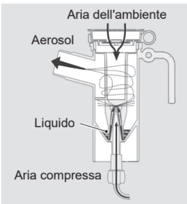
L'interruttore LC consente di interrompere la generazione di aerosol durante l'espirazione, ottimizzando in tal modo l'utilizzo del farmaco.
