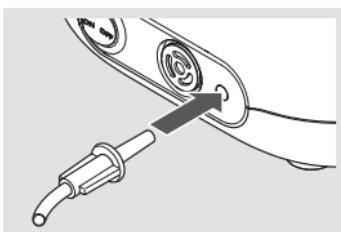
Priključno cev pršilnika z rahlim vrtenjem priključite v priključek za dotok zraka na kompresorju.
