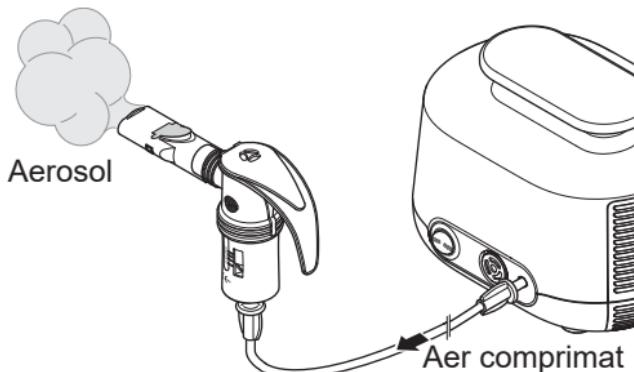
Compresorul alimentează nebulizatorul cu aer comprimat.
