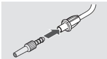
**⚠ VESZÉLY! Életveszély a tömlök felcserélése miatt!** Ha más készülékek tömlőrendszerei vannak a közelben (pl. infúziókhöz), akkor gondosan ellenőrizze, hogy a kompresszorhoz csatlakoztatott csatlakoztömlő a másik végén a porlasztóhoz csatlakozzon. Ellenkezőleg fennáll a veszélye, hogy a különböző csatlakoztatási lehetőségeket véletlenül felcseréljék egymással.
