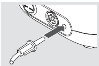
A porlasztó csatlakoztömlőjét könnyed mozdulattal csavarja a kompresszor sűrített levegő-csatlakozójába.
