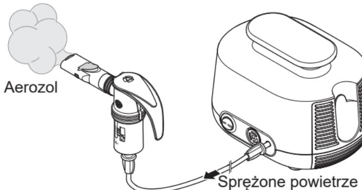
Kompresor dostarcza sprężone powietrze do nebulizatora.
