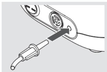
Εισαγάγετε τον ελαστικό σωλήνα σύνδεσης του νεφελοποιητή στην παροχή αέρος του συμπιεστή με ελαφρά περιστροφική κίνηση.
