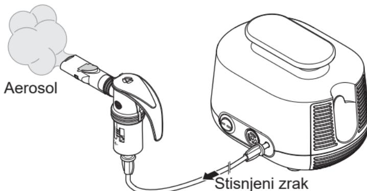
Kompressor napaja pršilnik s stisnjениm zrakom.
