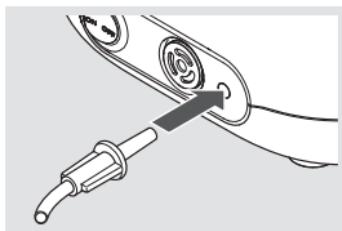
Podłączyć węzyk przyłączeniowy nebulizatora, wkręcając go delikatnie w przyłącze powietrza kompresora.
