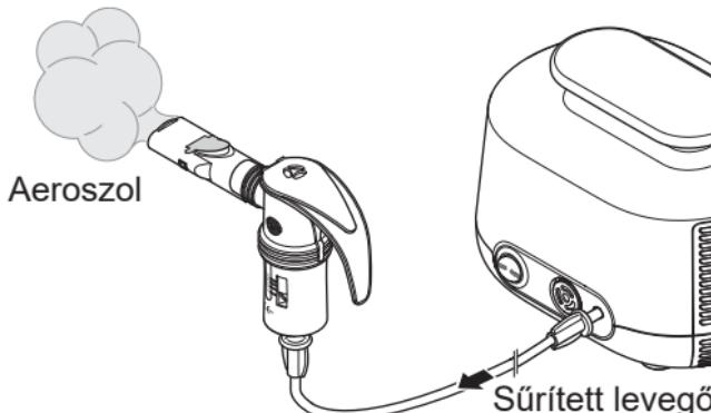
A kompresszor sűrített levegővel látja el a porlasztót.
