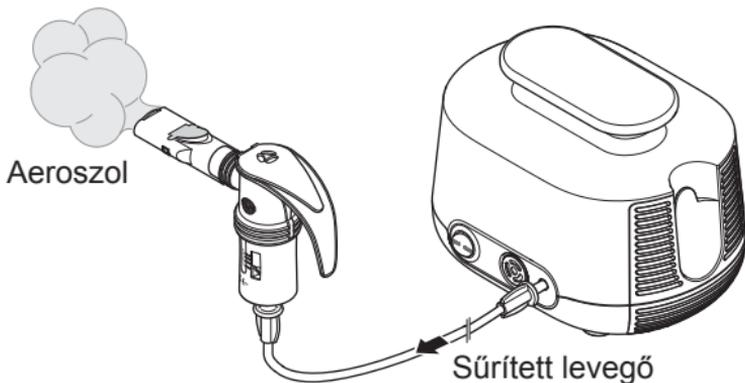
A kompresszor sűrített levegővel látja el a porlasztót.
