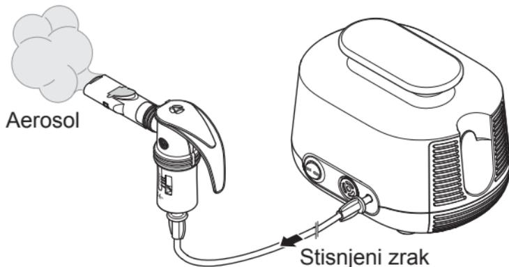
Kompresor napaja pršilnik s stisnjenim zrakom.
