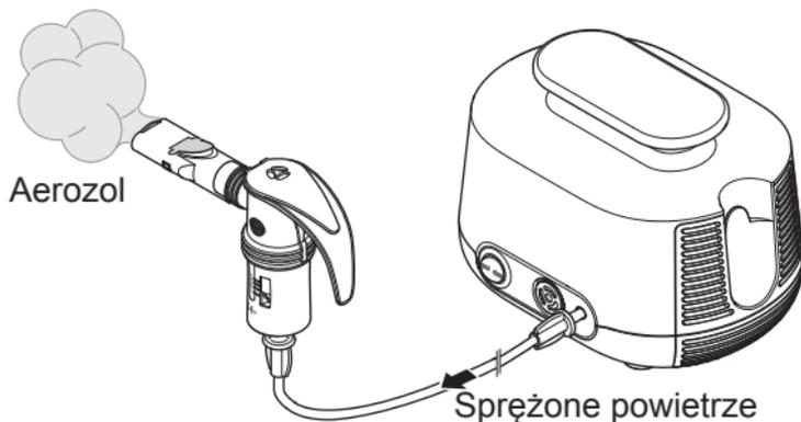
Kompresor dostarcza sprężone powietrze do nebulizatora.
