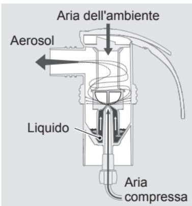
La dimensione delle goccioline di aerosol viene determinata dai diversi supporti dell'ugello. Più le goccioline sono piccole, più a fondo penetrano nelle parti più profonde e ridotte dei polmoni:
