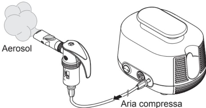
Il compressore alimenta aria compressa al nebulizzatore.
