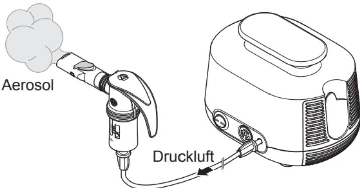
Der Kompressor versorgt den Vernebler mit Druckluft.
