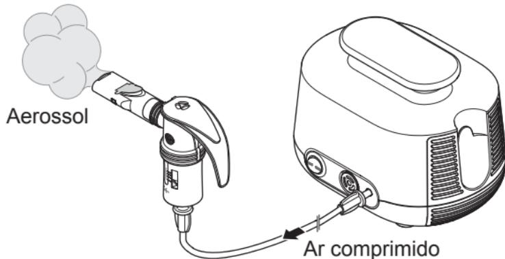
O compressor alimenta o nebulizador com ar comprimido.
