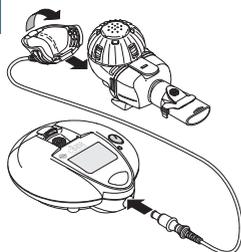
Raccordez le nébuliseur au générateur ; si nécessaire (usage sur secteur) raccordez le générateur à la prise de courant.
