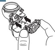
Raccordez la membrane en acier à la cuve de nébulisation.
