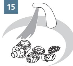
Rincez toutes les pièces sous le jet d'eau ; en particulier rincez les faces avant et arrière de la membrane en acier sous le jet d'eau.
