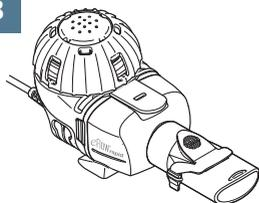
Le couvercle doit former un dôme continu et ne doit plus pouvoir tourner.
