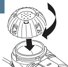
Placer le couvercle sur la cuve et faites-le tourner dans le sens des aiguilles d'une montre jusqu'à la butée.
