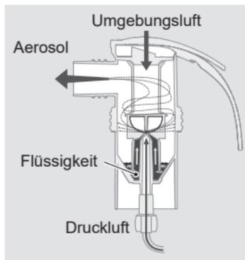
Die Größe der Aerosoltröpfchen wird durch die Düsenaufsätze bestimmt. Je kleiner die Tröpfchen sind, desto weiter dringen sie in die tieferen und kleineren Bereiche der Lunge vor:
