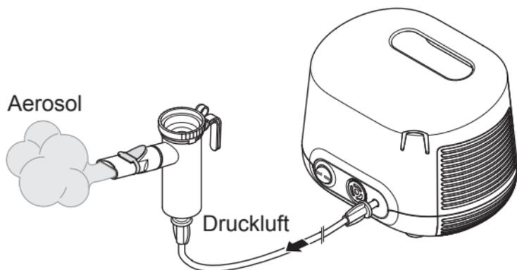
Der Kompressor versorgt den Vernebler mit Druckluft.
