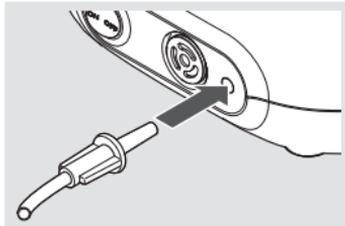
Stecken Sie den Anschluss Schlauch des Verneblers mit leichter Drehung in den Druckluftanschluss des Kompressors.
