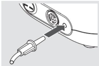
Stecken Sie den Anschlusschlauch des Verneblers mit leichter Drehung in den Druckluftanschluss des Kompressors.
