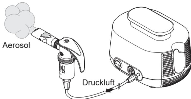
Der Kompressor versorgt den Vernebler mit Druckluft. Der Vernebler erzeugt bei Zufuhr von Druckluft Aerosol aus der eingefüllten Flüssigkeit, z. B. dem Medikament. Dieses Aerosol wird über das Mundstück oder ggf. über eine Maske in die Lunge eingeatmet.
