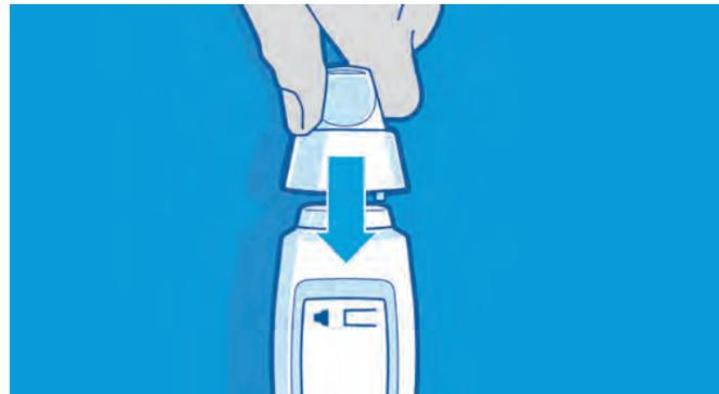
**Schritt 1:** Drücken Sie auf „Einschalten“. Nach einer kurzen Startphase erscheint auf dem Display die Aufforderung, das Einmal-Mundstück aufzusetzen. Setzen Sie es zügig in der korrekten Ausrichtung auf das Gerät.
