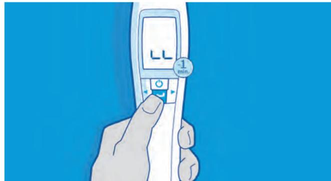
**Schritt 2:** Drücken Sie „ENTER“, um die Phase zu starten, in der das Gerät auf die Messung vorbereitet wird. Ist das Gerät startklar, erscheint das Symbol zum Ausatmen. Die Messung kann nun erfolgen.
