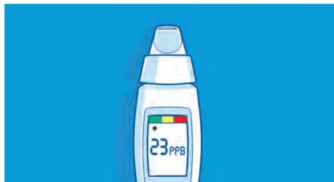
**Schritt 4:** Das Messergebnis wird direkt auf dem Display angezeigt. Über die Zuordnung zu den Ampelfarben haben Sie gleich eine erste Einschätzung Ihres Wertes und können über den Pfeil neben den Werten einen Trend ablesen. Nach der Messung entsorgen Sie das Mundstück ganz einfach im Hausmüll.
