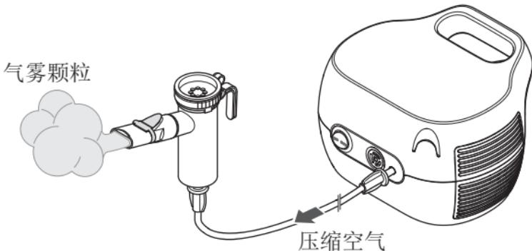
压缩机向喷雾器提供压缩空气。
