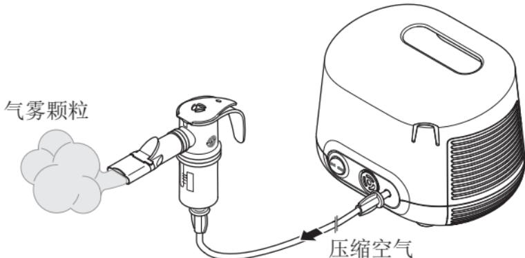
压缩机向喷雾器提供压缩空气。
