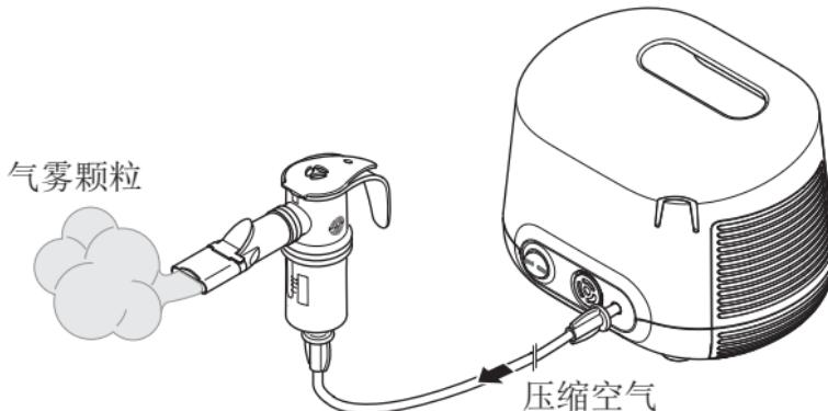
压缩机向喷雾器提供压缩空气。
