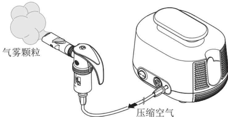
压缩机向喷雾器提供压缩空气。
